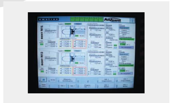
Дистанционное управление фирмы CG Emotron с прибором визуализации и управления PP42 – для комплексных систем и крупных установок с высокими требованиями
